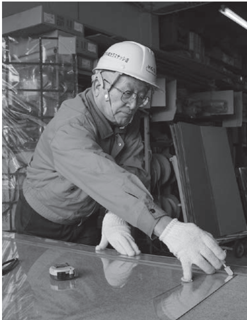
ガラスが割れたり、ひびが入ったりしないよう、絶妙な力加減と手の運びでガラスを切断していきます
